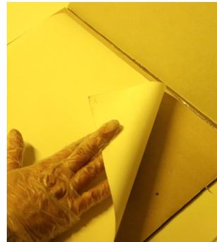
Posicionar sobre o papel *Ozalid* o fotolito com o desenho que se quer expor, com a superfície desenhada virada para baixo, encostando na superfície fotosensível.
