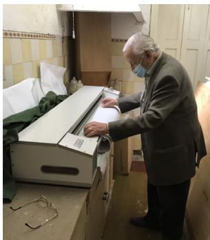
Fig. 6. Fotografia de uma máquina heliográfica usada pelo Arquiteto António Menéres, instalada no seu atelier.
