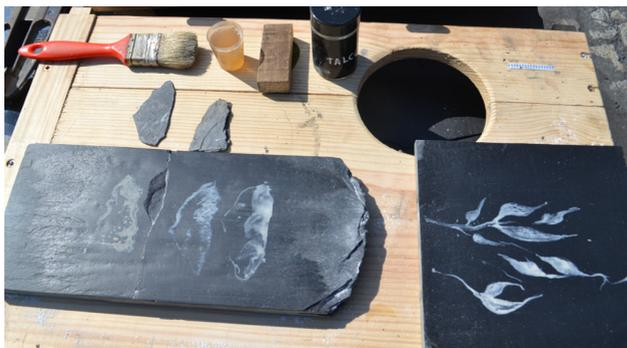
Opção por pedras de dimensões e espessura mais ajustados ao prelo para ensaio com prelo litográfico.
