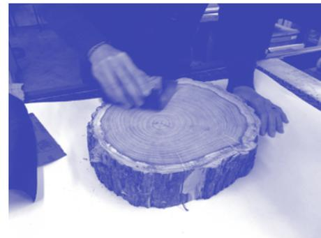
Finaliza-se o processo de lixagem com uma lixa de água de grão fino – 600 a 1200 – colocada à volta de um calço de madeira, para ser mais fácil manusear em círculos sobre a patela, que ficará desta forma absolutamente macia ao toque.
