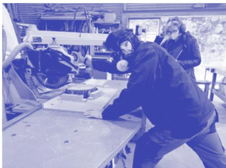
Recorre-se a uma radial de braço para nivelar a superfície irregular, resultante do corte de motosserra.
