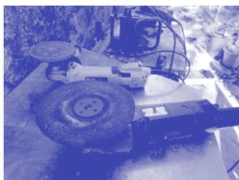
Para esta tarefa são utilizados dois tipos de máquinas e de lixas, nomeadamente polidora c/ discos de 180mm e lixadora de 125mm, com discos de lixa de grão 40 e 60.
