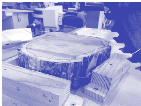
A serra vai desengrossando e nivelando a madeira. De notar o declive do corte prévio na imagem à esquerda. Esta tarefa tem que ser executada de ambos os lados da patela, para garantir que a mesma fica o mais nivelada possível. A fixação da patela é feita através de um suporte de ajuste, como se pode observar quer na imagem ao lado quer na que se segue.
