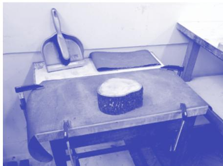
De salientar que o procedimento apropriado seria colar a cinta de lixa com cola de contacto, criando assim um plano de lixagem estável.
