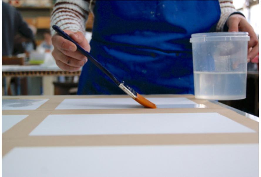
Fig. 8 | Preparação de tinta para impressão com esmalte vítreo e óleo de pinho, para impressão de decalque serigráfico.
