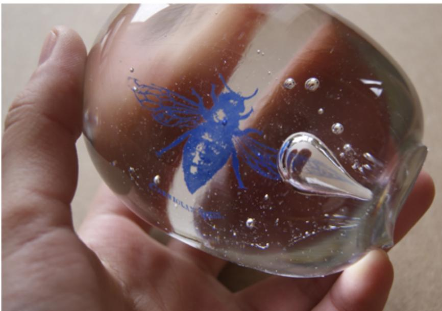
Fig. 16 | Amostra de vidro soprado com inclusão de decalque no interior da massa de vidro.
