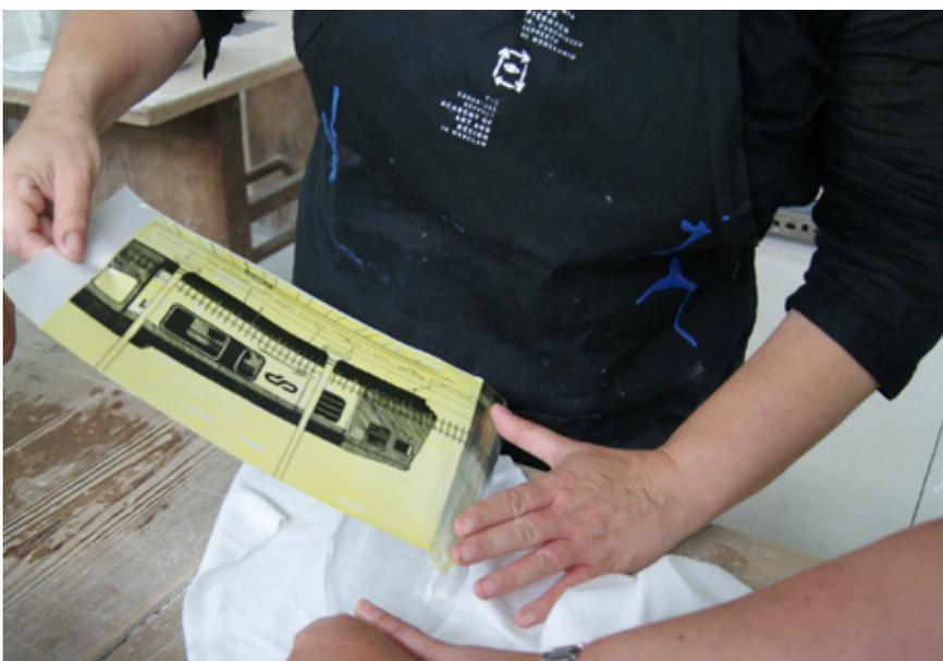
Fig. 3 | Aplicação de decalque serigráfico em garrafa de vidro cilíndrica.
