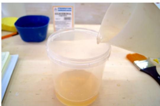
3 Adicionar algumas gotas de glicerina líquida e mexer a solução. A glicerina, usada como agente humectante, retém umidade na película de revestimento e aumenta a flexibilidade da mesma.
