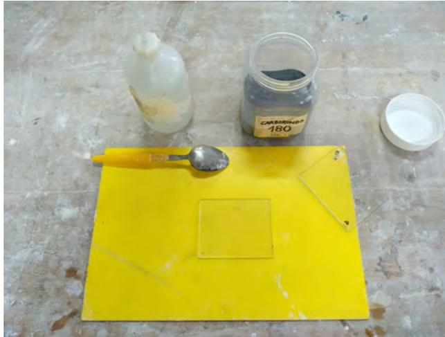
A abrasão manual é um processo de desgaste, causado pela movimentação, fricção e raspagem de partículas rígidas sobre uma superfície. Este processo produz uma gravação superficial, conferindo uma aparência fosca na superfície do vidro.
