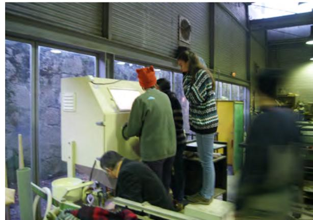
Processo de foscagem em cabina, utilizando carborundo de grão 150, como material de abrasão.
