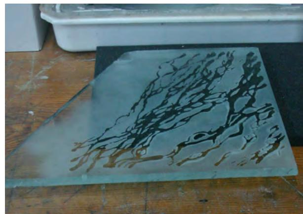
Ensaio com máscara de cola após foscagem e respetiva remoção da cola com gua quente.
