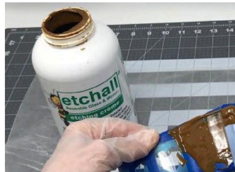
Pasta de acidulação para vidro *Etchall etching creme re-usable for glass*. É um material sob a forma de pasta que pode ser aplicado a pincel, desenhando sobre o vidro ou estendido com uma raquetele plástica sobre toda a superfície, utilizando máscaras e reservas.
