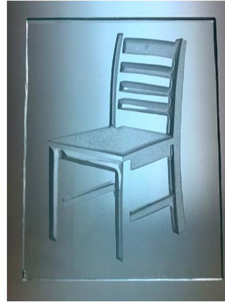
Amostra submetida à ação da temperatura. A foscagem fica atenuada mediante a temperatura utilizada. A 600°C, ainda temos foscagem, no entanto mais moderada (em cima). A 650°C a foscagem desaparece por completo, ficando apenas o relevo introduzido na superfície do vidro (conjunto em baixo).
