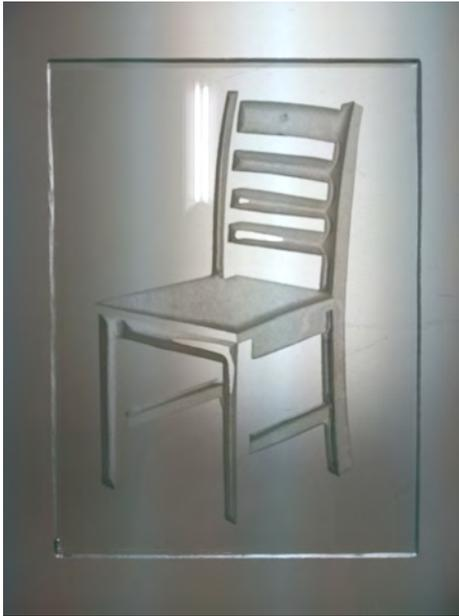
Amostra de imagem gravada com a técnica de foscagem com diferentes níveis de profundidade (em cima). Detalhe da textura presente na imagem (em baixo).
