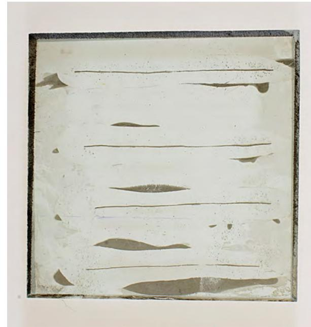
Gravação com *Etchall* sobre vidro *float*. Emulsão fotossensível *Dirasol 915* exposta durante 5", 10", 15", 20".
