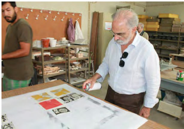
Como alternativa à laca usa-se também verniz em spray, para revestir o decalque.
