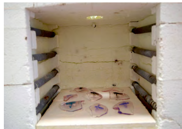
Colocação de peças de vidro com aplicação de decalques na mufla de fusão para queima da tinta, promovendo uma ligação permanente e durável ao suporte.
