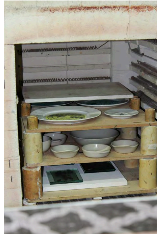
Preparação de programa de queima. As peças de cerâmica vidrada com aplicações de decalques são introduzidas no forno para queimar a laca e fundir o esmalte ao substrato.
