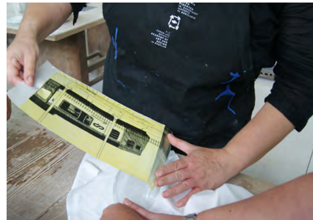
Demonstração da aplicação de decalque serigráfico em garrafa de vidro cilíndrica.
