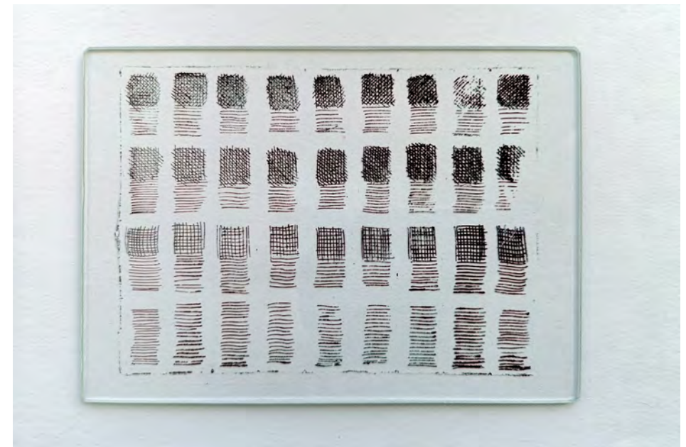
Ensaio de gravação de linha e trama com ácido. Decalque (em cima) transferência sobre vidro (em baixo). Diferentes períodos de mordedura, de 6-54 minutos. Verifica-se mais definição na transferência da imagem para vidro nos registos mais profundos.
