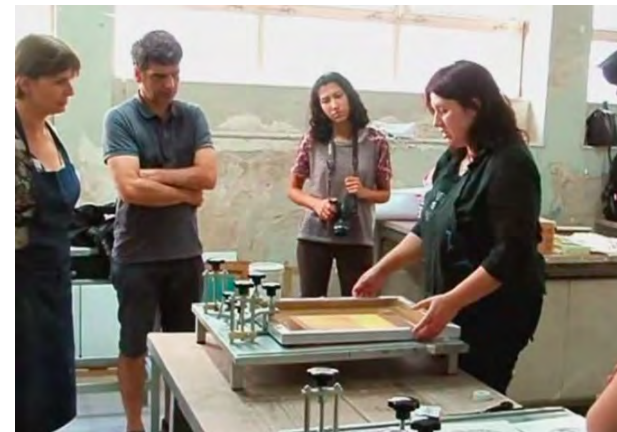
Malgorzata Warlikowska demonstra a aplicação de revestimento de laca, através de quadro serigráfico.
