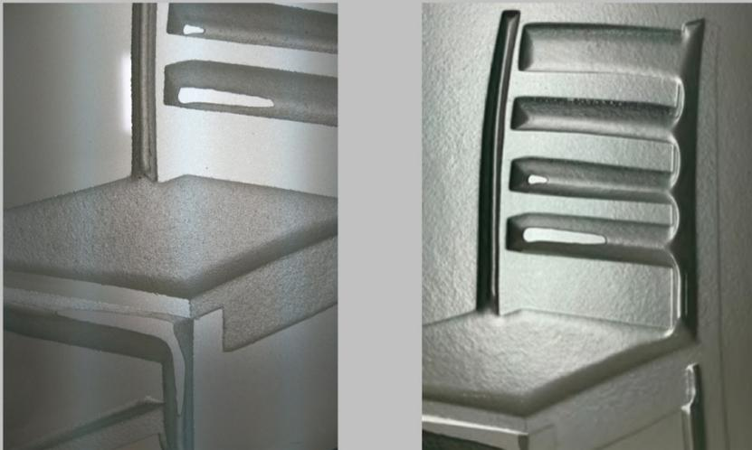
Amostra de gravação por abrasão mecânica, submetida a temperatura de 600° (à direita), e submetida posteriormente a 650° (à esquerda).
