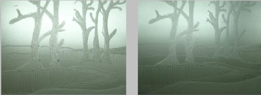
Amostra de gravação com pontas abrasivas e de diamante, antes de ser colocada na mufla (direita) e depois de ser submetida à temperatura de 600° (esquerda).
