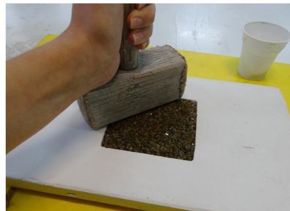
O vidro deve de estar bem compactado para evitar que a peça fique desnivelada. Neste caso, recorreu-se a um martelo de madeira para pressionar e assim compactar melhor o vidro granulado. Colocar o molde na mufla com o seguinte programa: 7h30 a subir até aos 750°C; 30min. em patamar nos 750°C; 45min. a descer até aos 550°C; 4h em patamar nos 550°C; 4h a descer até 470°C; 2h em patamar; 4h a descer até 370°C; 4h a descer até aos 30°C.
